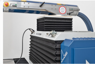
Höhe des Resonators motorisch verstellbar über W-Achse
