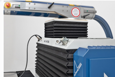
Hauteur du résonateur réglable par l'axe W.
