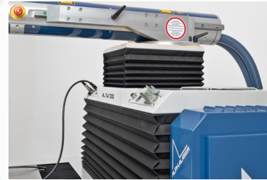
Hauteur du résonateur réglable par l'axe W.
